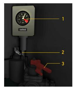
I Tacho2 Zusatzbremsventil3 Führerbremsventil
