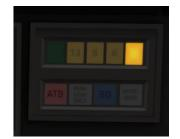
Wir erklären die Funktionsweise des aktivierten ATB anhand eines Beispiels. Im linken Bild fahren wir mit einer Geschwindigkeit von 125 km/h. Im rechten Bild wird dann eine Begrenzung auf 40 km/h angezeigt. Es ertönt ein Klingelton und Lampe 5 leuchtet auf.
