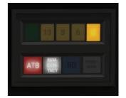
Der Mc betätigt das Führerbremsventil und die Bremskontaktleuchte 7 wird gezeigt (links). Bei Erreichen der befohlenen Geschwindigkeit von weniger als 40 km/h (mit einer Toleranz von 5 km) ertönen kurz hintereinander drei Glockensignale ("ting ting ting").
