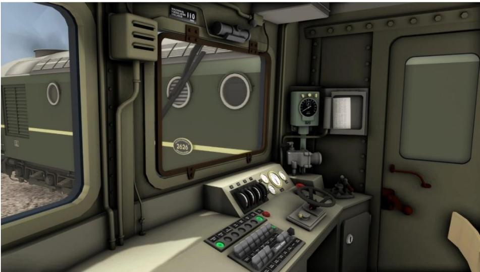
Übersicht über den Führerstand mit dem Faiveley-Block und den Kontrollleuchten im Vordergrund. Oben rechts ist der Tachometer von Hasler mit 24-Stunden-Uhr zu sehen, über den Fenstern befinden sich die Hebel, mit denen die Druckluftzufuhr zu den Wischermotoren freigegeben werden kann (die auch auf die «V»-Taste reagieren). Die anderen Steuerelemente werden auf den folgenden Seiten erläutert.
