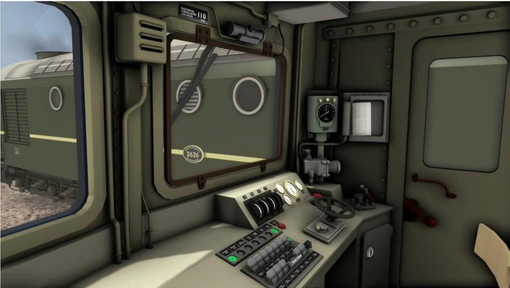
Overzicht van de stuurstand met op de voorgrond het Faiveleyblok en de meldlampen. Rechtsboven zie je de Hasler-tachograaf met een 24-uurs klok en boven de vensters zitten de hendels waarmee toevoer van perslucht aan de ruitenwissersmotoren kan worden vrijgegeven (die reageren ook op de 'V'-toets). De andere bedieningsorganen worden op de volgende pagina's toegelicht.
